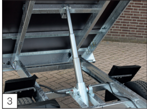
Serienausstattung: ausgestattet mit einem soliden, 3-stufigen Hydraulikzylinder.
