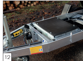
Option: elektrische Bedienung mit Batterie anstelle der Handpumpe.
