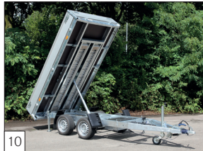
Option: „Auffahr“-Paket: 2 integrierte Aluminium-Auffahrschienen, 2500 mm lang, mit 2 stabilen Kurbelstützen mit Kurbel.
