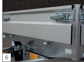
Serienausstattung: mit 4 soliden Eckrungen und einer klappbaren Vorderwand.
