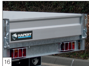
Option: Abschirmung der Heckleuchte, Heckbordwand oben und unten pendelnd (nur möglich in Kombination mit Bordwänden 400 mm hoch).
