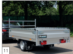
Option: Combi Protect Rail seitlich an Aluminium-Bordwänden montiert.
