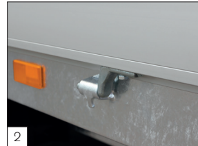
Serienausstattung: bei Scharnierpunkten angebrachter Haken zur einfachen Befestigung von z.B. dem Ladungsnetz.
