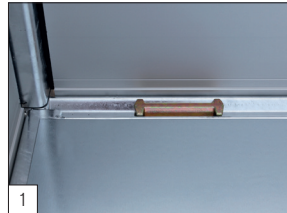
Serienausstattung: TÜV-geprüfte Verzurrbügel.
