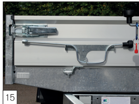
Option: Kurbel für Kurbelstützen an der Vorderseite montiert.
