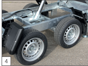
Serienausstattung: ein niedriges Fahrgestell mit Bereifung 195/50 R13.
